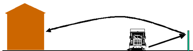
Figuur 2 : het effect van reflecties tegen een scherm aan de overzijde van de weg
